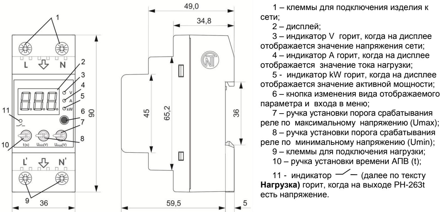
**Рисунок 1 – Органы управления и габаритные размеры РН-263т**
