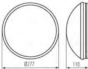
Kanlux PIRES – это потолочный светильник в минималистском стиле, оснащённый микроволновым датчиком движения с дальностью обнаружения движения 9 м. Преимуществом данного светильника является также возможность регулировки времени освещения в диапазоне от 8 секунд до 12 минут.
