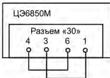
Рисунок 4.5 – Схема подключения резисторов растяжки
