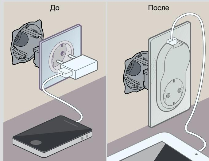
Расширяет возможности розеток 2K+3: устанавливается вместо розетки 2K+3 без добавления каких-либо вспомогательных устройств.
