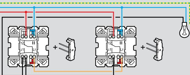
С использованием светодиодного модуля Кат. № 0 676 70
