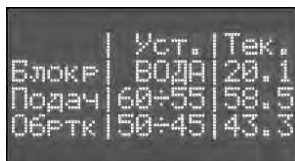
Рисунок 14.34 – Раздел Экран 1: а – неисправность силовых каналов; б – отсутствие протока в системе
