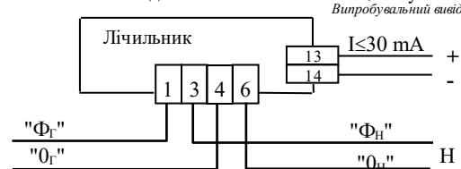
Рисунок 2 – Схема підключення лічильника ЦЭ6807Б-У в корпусі ШБ
