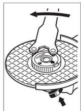
Закріплену належним чином, непошкоджену швидкозатискну гайку можна відпустити, вручну повертаючи кільце з накаткою проти стрілки годинника. **Ніколи не відкручуйте швидкозатискну гайку, яка сидить дуже міцно, кліщами – використовуйте ріжковий ключ під два отвори.**
