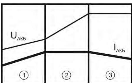
**Рисунок 4 - Стадии заряда для АКБ типа  $LiFePO_4$**
