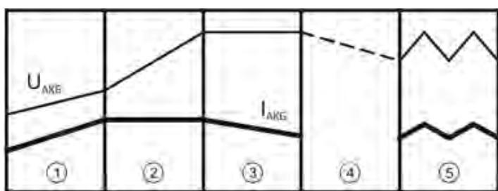
**Рисунок 3 – Стадии заряда для АКБ типа AGM и GEL**
