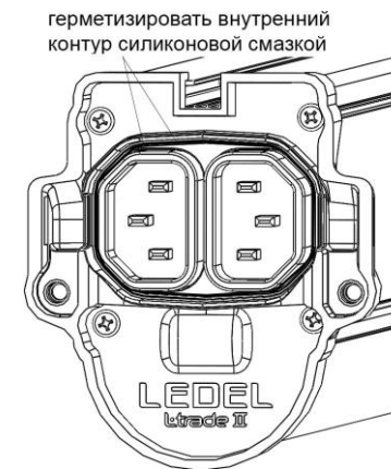
Рисунок 5 Герметизация соединений EASY LOCK 2.0
