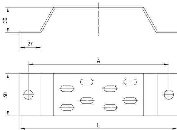
Рисунок 6 – Стойка настенная
