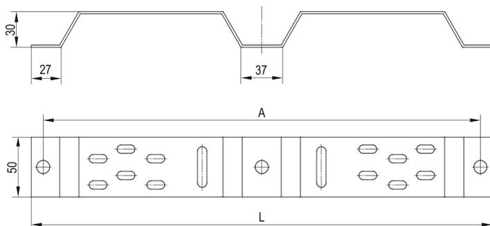
Рисунок 7 – Стойка настенная
