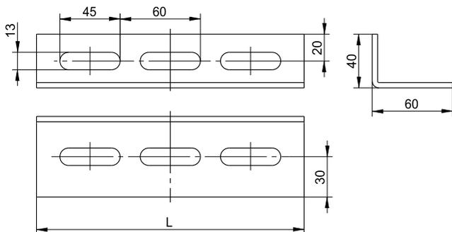
Рисунок 13 – Профиль перфорированный L-образный ГЭМ К242
