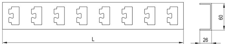
Рисунок 5 – Стойка кабельная
