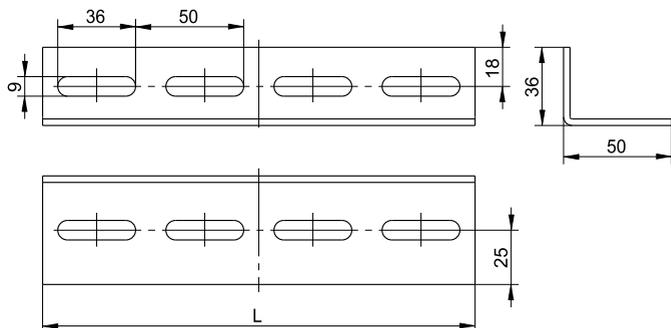
Рисунок 12 – Профиль перфорированный L-образный ГЭМ К237
