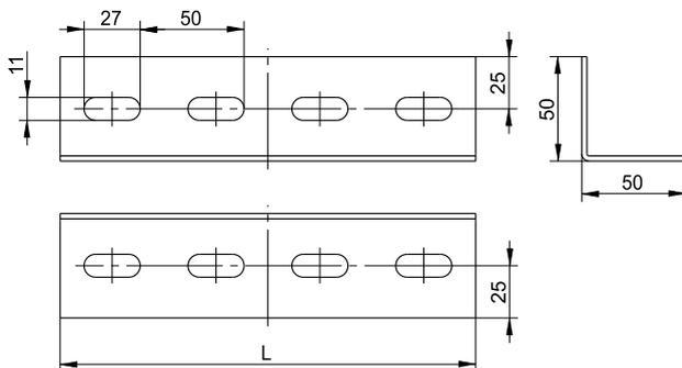
Рисунок 14 – Профиль перфорированный L-образный L-2,5
