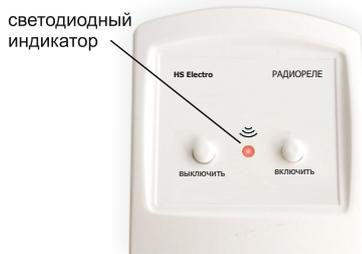
Нажмите одну из кнопок на новом пульте. Светодиод на силовом блоке загорится на 2 секунды и погаснет.
