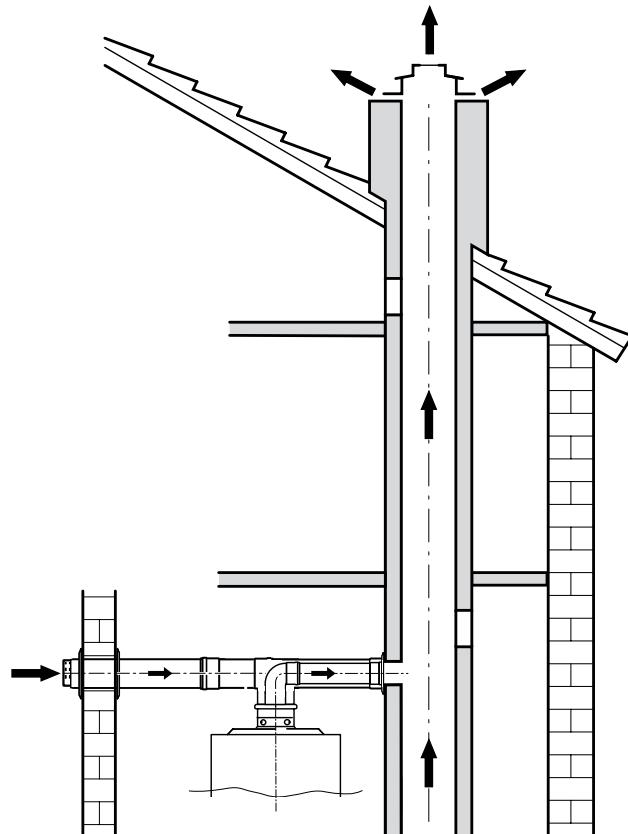
6/14 Концентрическое дымоотведение по С82x
