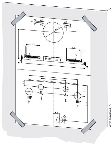
**1/5** Монтажный шаблон для подключения
