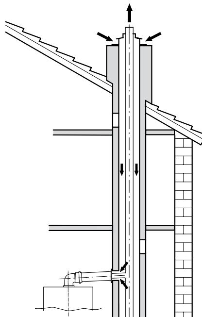
6/10 Концентрическое дымоотведение по С42x
