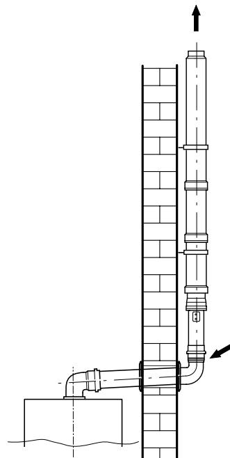
6/12 Концентрическое дымоотведение по С52x
