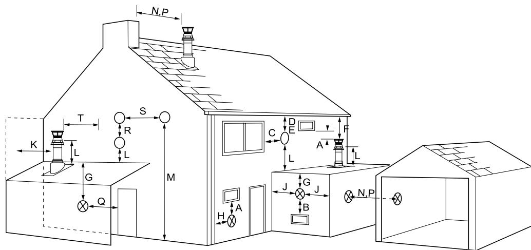
**6/1** Определение положения трубопровода отвода дымовых газов снаружи здания относительно наружных конструктивных элементов здания
