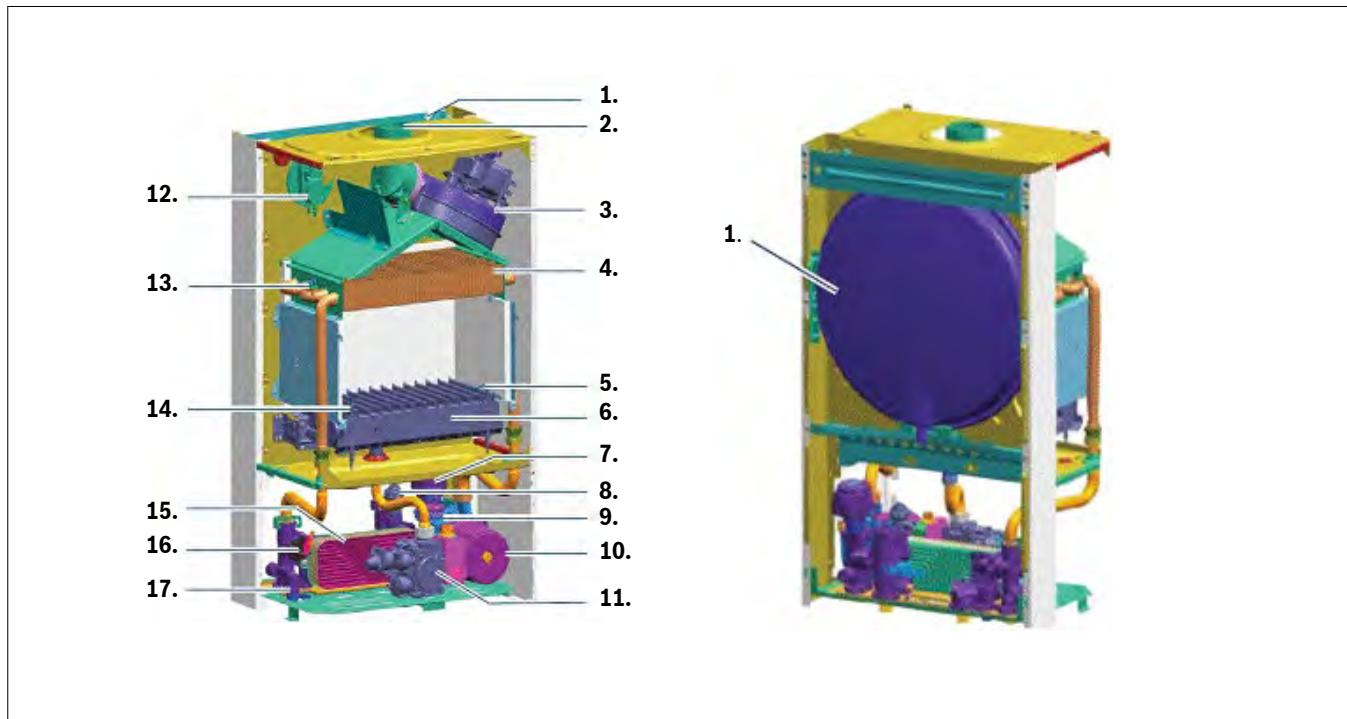
**1/4 Конструкция настенного газового котла Gaz 6000 W**
