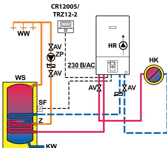
**3/2** Пример гидравлической схемы системы отопления с одноконтурным котлом Gaz 6000 W WBN – 24 HRN: один отопительный контур без смесителя, без гидравлического разделителя и с приготовлением горячей воды в баке косвенного нагрева
