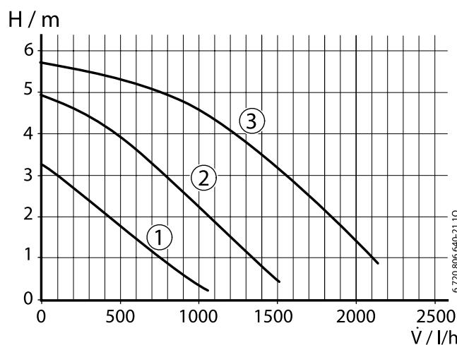
**2/1** Диаграмма остаточного напора циркуляционного насоса котла Gaz 6000 W
