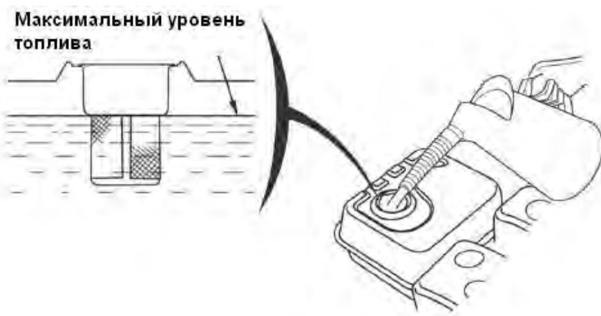
Заправляйте горючим на открытом воздухе или в хорошо проветриваемом помещении перед запуском двигателя. Если двигатель был в работе, позвольте этому охладиться. Заправляйте горючим осторожно, избегая пролива топлива. Не заполняйте топливный бак выше **фильтра крышки** топливного бака. После дозаправки, надежно завинтите крышку топливного бака.
