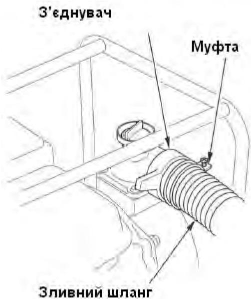
Краще використовувати короткий шланг більшого діаметра, тому що це зменшить опір шланга потоку води й поліпшить продуктивність насоса.
