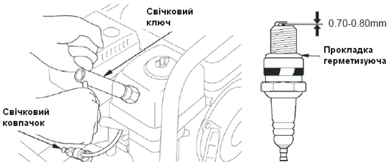
4. Виміряйте проміжок електроду свічки запалення відповідним вимірювальним інструментом. Відрегулюйте проміжок у разі потреби, обережно згинаючи бічний електрод. Проміжок має бути від 0.70 до 0.80 мм.
