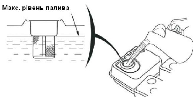
Заправляйте пальним на відкритому повітрі або в добре провітрюваному приміщенні перед запуском двигуна. Якщо двигун був у роботі, дозвольте йому охолонути. Заправляйте пальним обережно, уникаючи протоки палива. Не заповнюйте паливний бак вище фільтра кришки паливного бака. Після дозаправлення, надійно закрійте кришку паливного бака.
