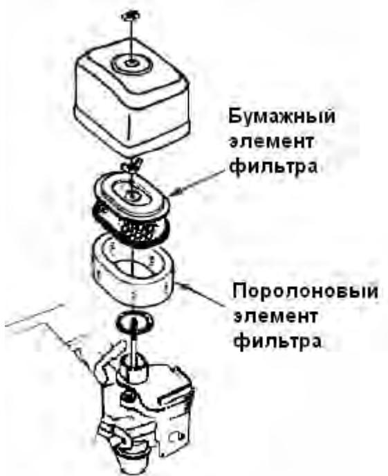
**Работа двигателя без воздушного фильтра, с поврежденным или загрязненным воздушным фильтром приведет к тому, что грязь и абразивные частицы с воздухом будут беспрепятственно поступать в двигатель, вызывая быстрый износ двигателя.**
