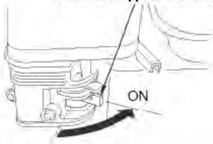
3. Для пуску холодного двигуна пересуньте **важіль повітряної заслінки** в положення ЗАКРИТЕ (CLOSED). (Для пуску прогрітого двигуна залишіть важіль у положенні ВІДКРИТЕ (OPEN)).
