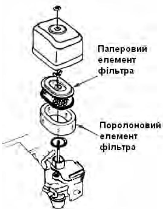
**Робота двигуна без повітряного фільтра, з ушкодженим або забрудненим повітряним фільтром приведе до того, що бруд і абразивні частки з повітрям будуть безперешкодно потрапляти у двигун, викликаючи швидке зношування двигуна.**
