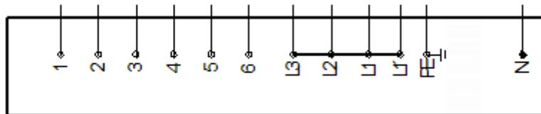
Для однофазного підключення котла потрібно із клемника демонтувати перемичку яка з'єднує клеми L1 і L1'. Потім потрібно поставити перемичку яка з'єднує клеми L1', L1, L2, L3. Фазний провід потрібно приєднати до клеми L1.
