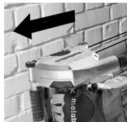
Всегда ведите инструмент сквозь обрабатываемый материал в предписанном направлении! См. стрелку (11) на защитном кожухе. В противном случае круг может заклинить, отскочить из заготовки или вызвать отдачу.
