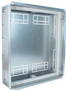
Изготовлена из листовой оцинкованной стали толщиной 1 мм. Имеет перфорацию отверстий для прокладки кабелей и проводов. Также имеет перфорацию для монтажа в нише. Болты М6x40, которые поставляются в комплекте, служат только для позиционирования кассеты. Окончательный монтаж производится с помощью распорных дюбелей (в кассете отверстия диаметром 9мм и 6 мм) и монтажной пены (в кассете имеются отверстия для заполнения монтажной пеной).
