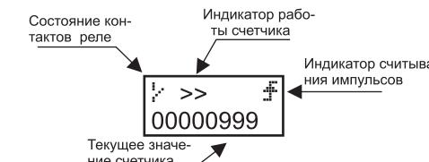
Достижение значения, установленного потребителем, отмечается замыканием контактов встроенного реле. Одновременно прекращается подсчет импульсов, подсветка дисплея начинает мигать(три раза), а на дисплее отображается надпись STOP.
