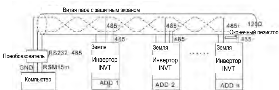
Рис. 2: Схема последовательного подключения
