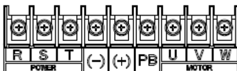
Рис. 3-8: Клеммы силовой цепи трехфазного инвертора (мощностью 45–110 кВт)
