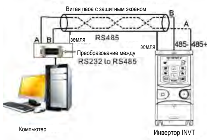
Рис. 1: Подключение по протоколу RS485
