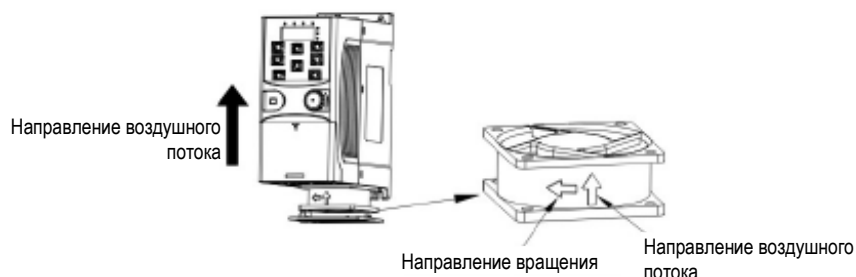
Монтаж вентилятора в инверторах: 1 фаза / 220 В, мощностью менее 2,2 кВт
