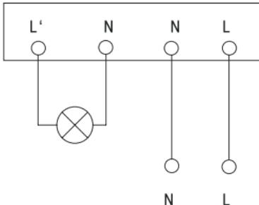
Рисунок 16 – Схема подключения датчика ДД-026
