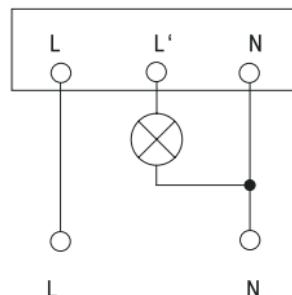
Рисунок 19 – Схема подключения датчика ДД-401
