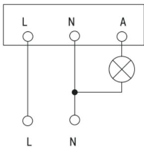
Рисунок 17 – Схема подключения датчика ДД-201
