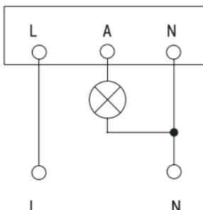
Рисунок 18 – Схема подключения датчика ДД-301
