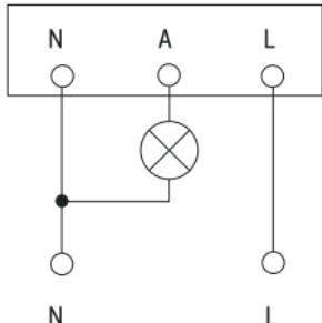
Рисунок 15 – Схема подключения датчика ДД-025, ДД-027
