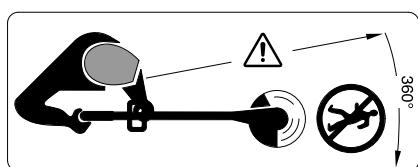
Varmista, että sivulle sinkoutuvat vieraita esineet eivät loukkaa lähellä seisovia ihmisiä.
