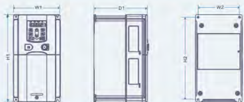
Настенный монтаж преобразователей 18,5 ~ 30кВт
