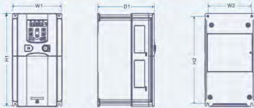
Схема установки для ПЧ 11—15кВт
