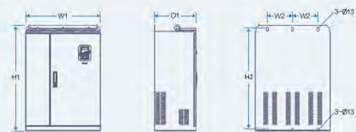
Настенный монтаж преобразователей 220 ~ 350кВт
