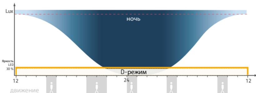
❶ Светильник горит постоянно с установленной яркостью.
