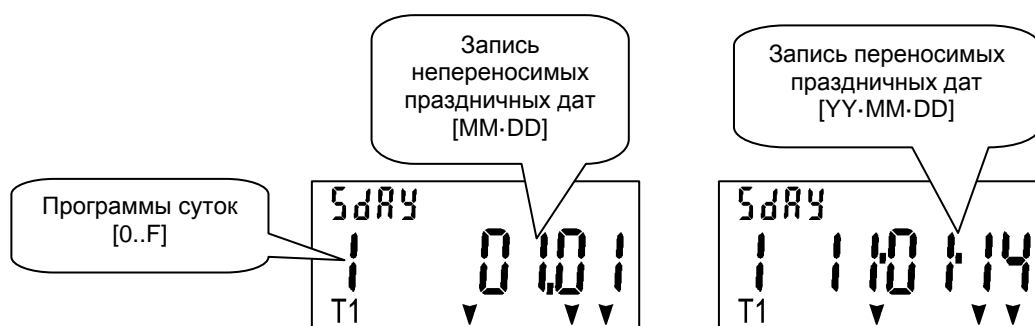
Рис. 11-8 Пояснения к отображаемому на индикаторе циклу просмотра списка праздничных дней
