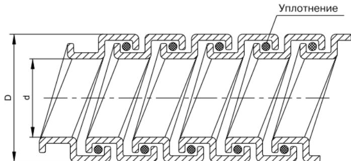
Рисунок 3 – Металлорукав типа РЗ-ЦХ, РЗ-ЦХ с протяжкой
