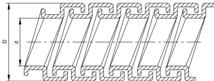
Рисунок 2 – Металлорукав типа РЗ-Ц и РЗ-Н
