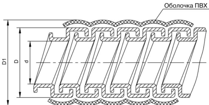
Рисунок 1 – Металлорукав типа РЗ-ЦПнг и РЗ-ЦПнг-ХЛ с протяжкой
