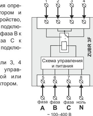
Схема 1. Упрощенная внутренняя схема и схема подключения
