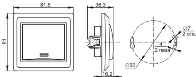
Рисунок 3 – Габаритные размеры выключателя BS10-1-1-BB
