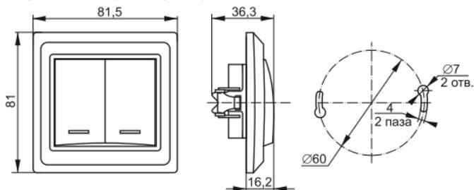
Рисунок 5 – Габаритные размеры выключателя BS10-2-1-BB
