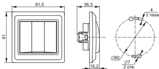
Рисунок 6 – Габаритные размеры выключателя BS10-3-0-BB
