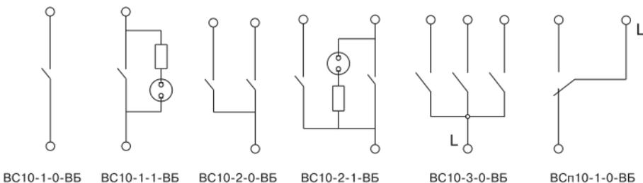
Рисунок 1 – Электрические схемы выключателей
