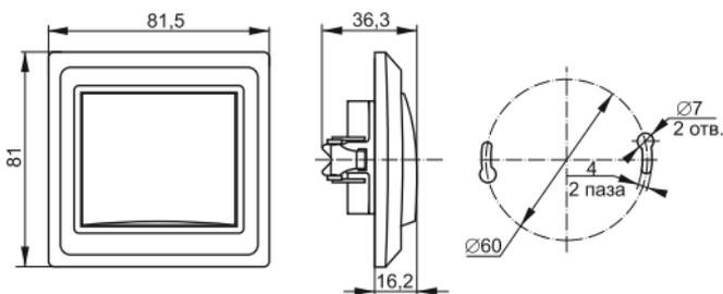
Рисунок 2 – Габаритные размеры выключателя BC10-1-0-ВБ, BCn10-1-0-ВБ
