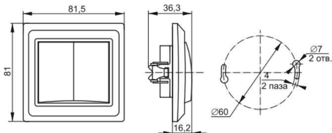
Рисунок 4 – Габаритные размеры выключателя BS10-2-0-BB
