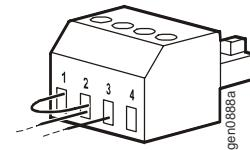
Если контакты разомкнуты, ИБП ВЫКЛЮЧИТСЯ, и питание нагрузки будет отключено.
