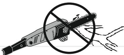
12. Следите за ветвями, которые находятся за спиливаемой ветвью. Если цепь заденет дальнюю ветвью, то возможен «обратный удар» и потеря контроля над высоторезом (см. рисунок 13).
