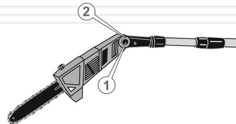
Угол наклона направления шины можно изменять в пределах 0°-30° (три фиксированных положения).
