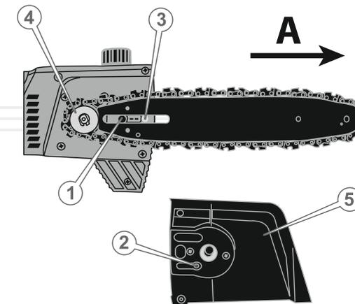
9. Установіть притискну кришку шини (5) (див. малюнок 5). Закрутіть безключову гайку, не затягуючи її.
