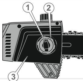
1. Бесключевая гайка крепления прижимной крышки.
