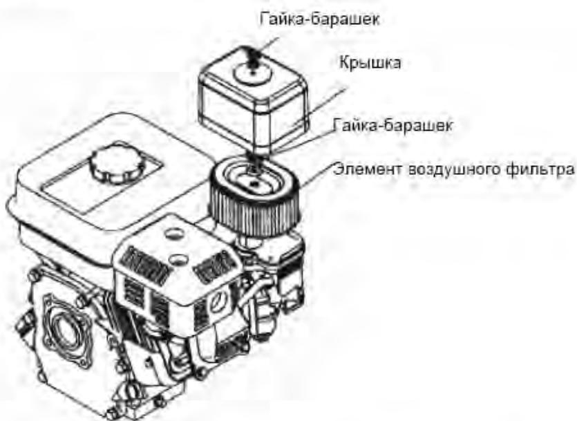
**Бумажный элемент:** Слегка похлопайте элементом несколько раз по твердой поверхности, чтобы стряхнуть излишек грязи, или продуйте фильтр сжатым воздухом изнутри наружу; чистка щеткой загонит грязь в волокна. Замените бумажный элемент, если он особенно грязен.
