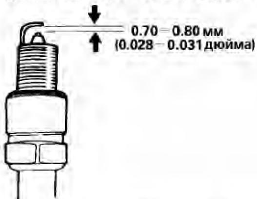
4. Проверьте, в хорошем ли состоянии шайба свечи зажигания, и завинтите свечу рукой, не допуская перекоса.
