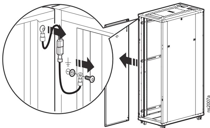
3. Переверните дверь и перевесьте ее на противоположную сторону. Удалите все пластмассовые заглушки отверстий и снова прикрепите заземляющий провод к дверце и шкафу.
