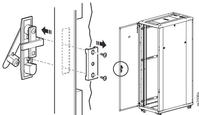
2. Отсоедините провод заземления от шкафа и дверцы, затем снимите дверцу.
