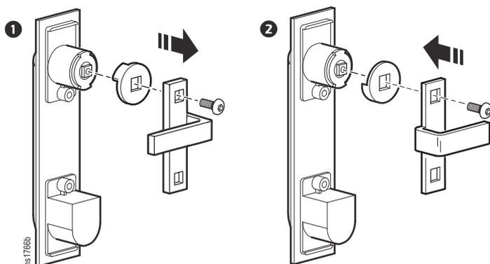
5. Установите ручку на дверцу. Затяните винты с усилием 3,2-3,4 Нм (28-30 дюйм-фунт).
