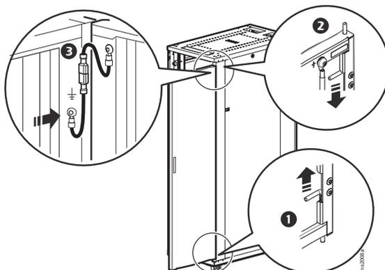
4. Снимите и переставьте фиксатор и шайбу, как показано на рисунке, используя гаечный звездообразный ключ Torx T30/Phillips № 2. Шайба поворачивается на 90 градусов относительно исходного положения; фиксатор поворачивается на 180 градусов.
