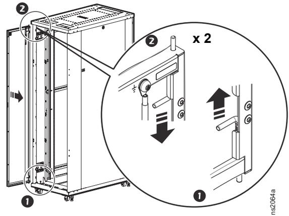
3. Подключите провода заземления.
