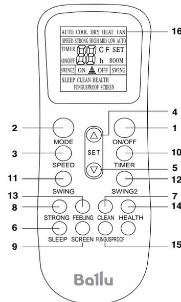
1. Кнопка ON/OFF – включение/выключение.
