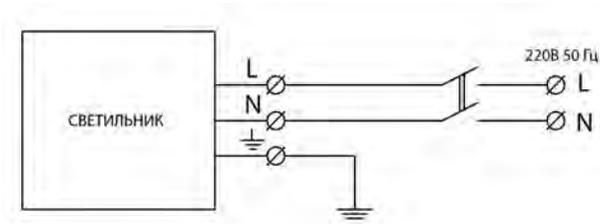
Рисунок 2 Схема подключения светильника
