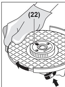
Для фиксации шлифовального шпинделя нажмите кнопку фиксирования шпинделя (1). Чтобы затянуть быстрозажимную гайку, поверните шлифовальный круг с усилием по часовой стрелке.
