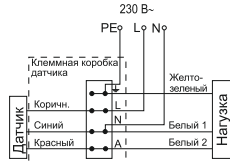
Рисунок 18 – Схема подключения датчиков ДД-017, ДД-019
