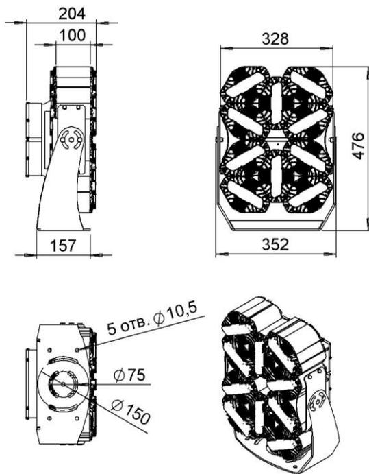
Рисунок 2 Светильник «L-lego II 500 banner» с баннерным креплением.
