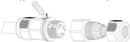
5. Продеть кабель через крышку с зажимной гайкой. Зачищенные провод вставить в отверстие на разьеме так, чтобы только оголённая часть провода оказалась внутри клеммы. Подключение проводов в разьеме производить строго в соответствии с обозначением на торцевой поверхности центральной части коннектора. Закрепить провода в клеммах закрутив винты клемм.
