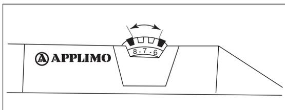
С правой стороны находится включатель и термостат. Конвектор начинает работать, когда переключатель переводится в положение I. Термостат позволяет автоматически поддерживать постоянную температуру в помещении.
