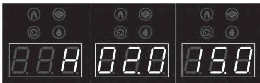
Рисунок 8 — Установка пауз включения и выключения насоса
