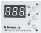
При включении устройства на индикаторе 2 с висвечиваются три восьмерки.
