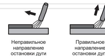
Для получения прочного сварочного соединения кроме правильного выбора сварочного тока необходимо обеспечить правильное положение электрода относительно свариваемой поверхности. Угол наклона электрода должен составлять 60-80 градусов (см. рисунок 4). При слишком большом угле наклона сварочный шов может стать пористым, при слишком малом угле – образуется большое количество брызг расплавленного металла, и дуга становится неустойчивой.
