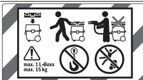
Для транспортировки пылесоса и для экономии места при хранении принадлежностей пылесоса и/или электроинструмента на крышке пылесоса можно установить кейс L-Voxx.
