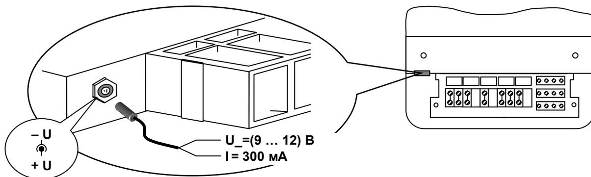
По требованию заказчика счетчики могут быть оснащены разъемом для подключения внешнего источника питания. В этом случае разъем находится слева от клеммной коробки. Подключение внешнего источника питания осуществляется посредством ответной части разъема из комплекта поставки счетчика.
