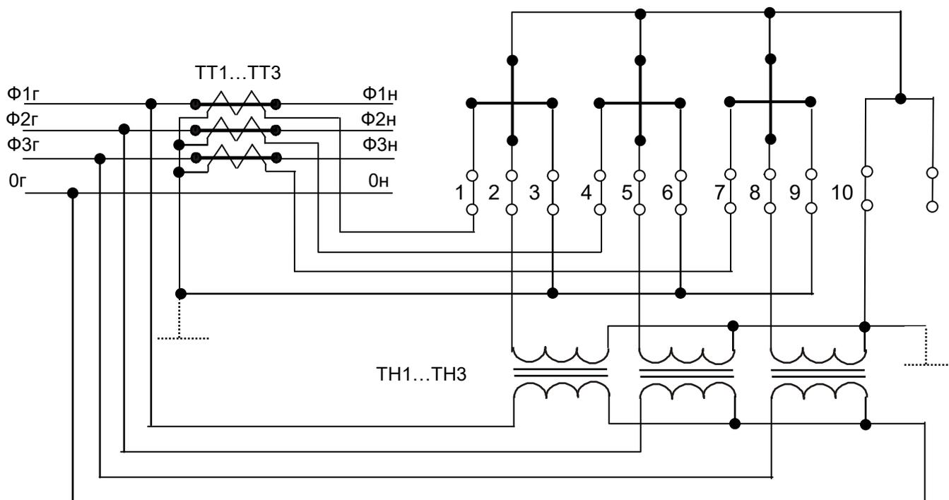
**Примечание.** – При данной схеме включения счетчика заземление нейтрали рекомендуется как элемент снижения воздействия «шумовых» факторов. Допускается включение счетчика в схему с незаземленной нейтралью
