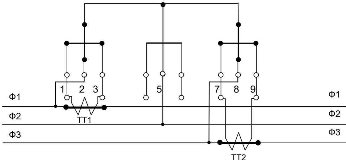
Вариант 2 (трансформаторное включение по напряжению и току)
