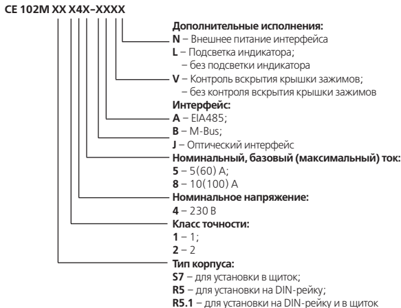
Рисунок 3.1 – Структура условного обозначения счетчика
