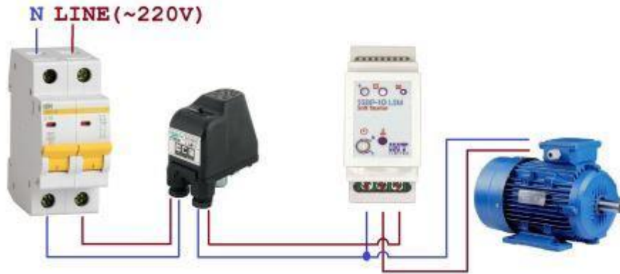
мал. 4 Можлива схема підключення при автоматичному режимі
