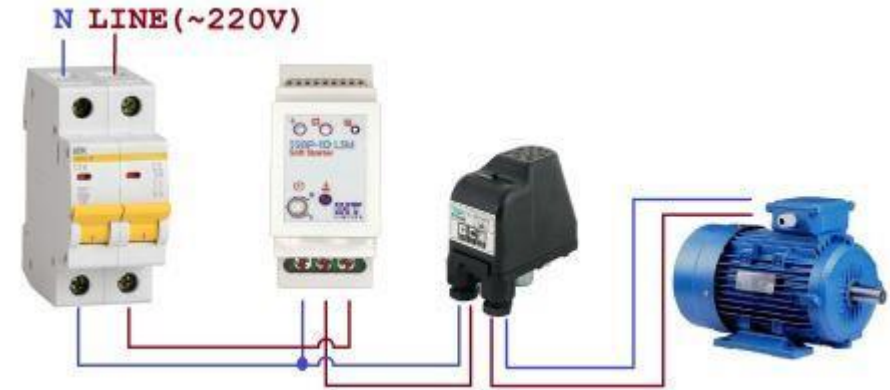
Мал. 5. Схема з'єднань у режимі SMART.
