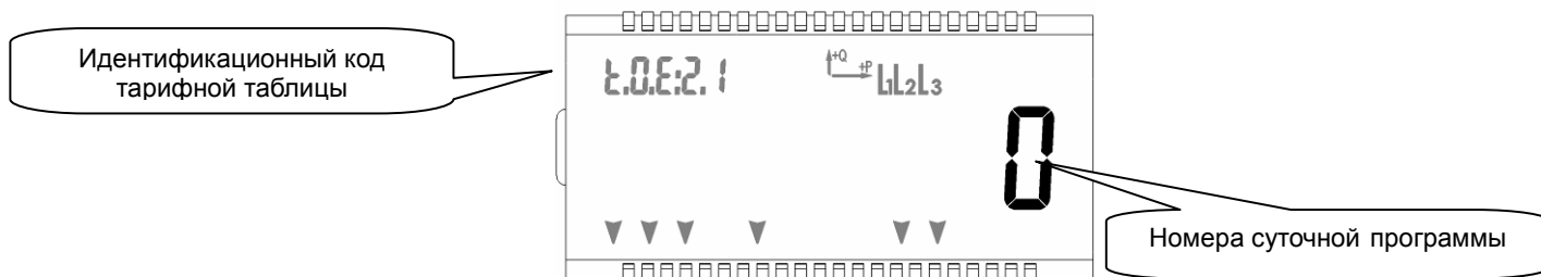
Рис. 22: Расположение Номера суточной программы на ЖКИ
