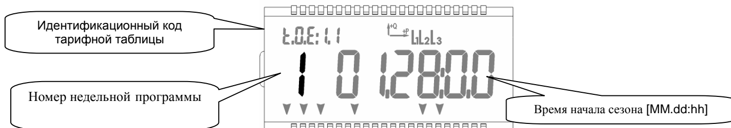
Рис. 21: Расположение Номера недельной программы на ЖКИ
