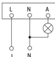
Рисунок 12 – Схема подключения датчика ДД-МВ301
