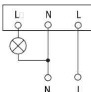
Рисунок 13 – Схема подключения датчика ДД-МВ501
