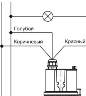
Рисунок 14 – Схема подключения датчика
