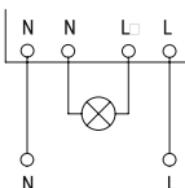
Рисунок 11 – Схема подключения датчика ДД-МВ201
