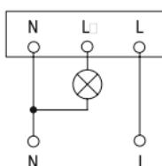
Рисунок 10 – Схема подключения датчиков ДД-МВ101, ДД-МВ401
