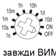
Рисунок 6 - Положення регулятора часу затримки та діапазон часу затримки при кожному положенні регулятора.
