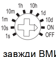
Рисунок 6 - Положення регулятора часу затримки та діапазон часу затримки при кожному положенні регулятора.
