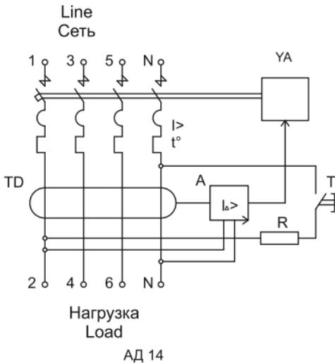
Рисунок 2 – Схемы электрические выключателей
