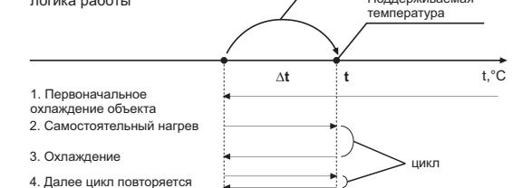
Гистерезис - это разница между температурой включения и отключения контактов реле терморегулятора (падение температуры).
