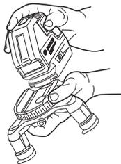
Приставьте измерительный инструмент направляющим пазом **15** к направляющей рейке **16** поворотной платформы **19** и вставьте измерительный инструмент до упора на поворотную платформу. Для снятия потяните измерительный инструмент в обратном направлении с поворотной платформы.
