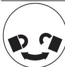
Направление вращения винта с накатанной головкой для фиксации/ослабления углового упора на передвижном столе.
